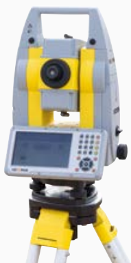
Hochpräzise Robotik-Totalstation mit moderner Android-Software X-PAD Ultimate Seite 193
