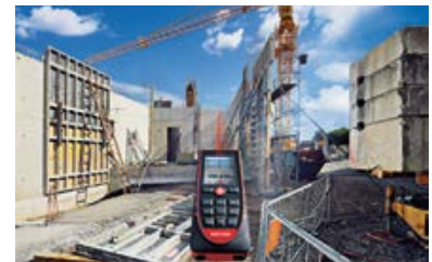
D510 - Horizontaldistanz mit Schrägmessung und Geräteneigung
