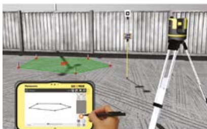
Flächenmessung im Außenbereich
