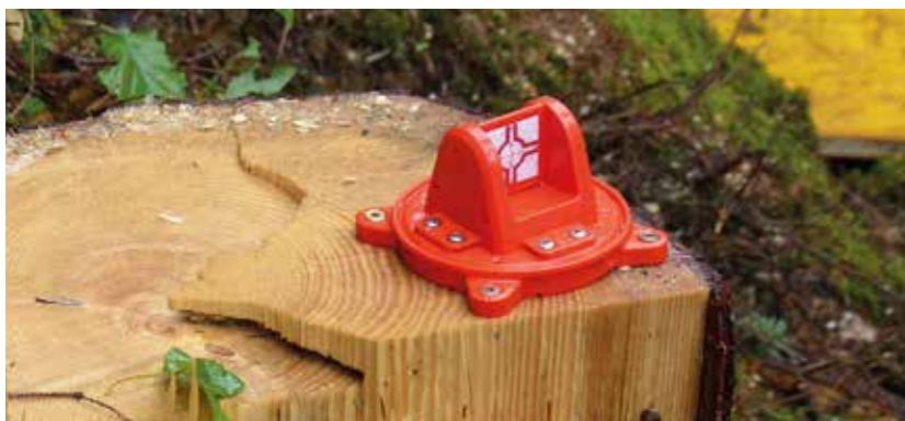
Einsatzbeispiele RS193rM als Fixpunkt auf unterschiedlichen Oberflächen und zum exakten Ausrichten der Bohrlafette.
