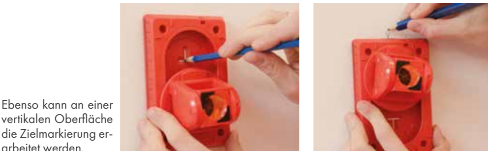
Prisma zur Seite schieben und die Zielposition mit einem Stift markieren.
