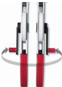
Der Ergoline-Rahmen lässt sich schnell von Rechts- auf Linkshänder umbauen
