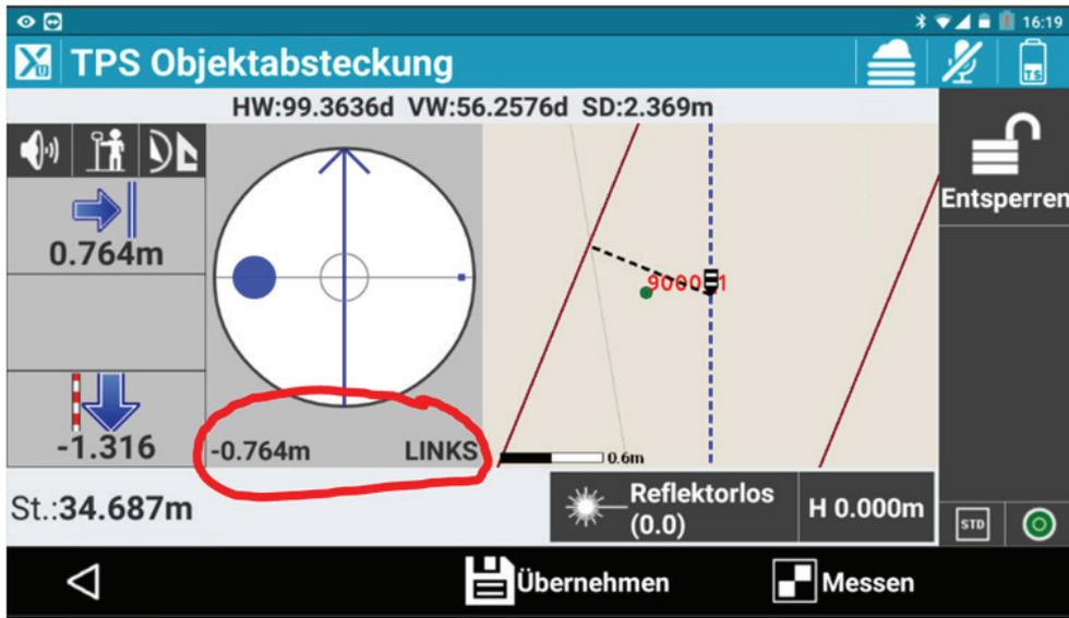
3.) Tippen Sie auf „Messen“, um die erste Messung auszuführen. Nun zeigt Ihnen die Software unterhalb des Kreises an, wie weit Sie sich links oder rechts der Zielachse befinden. Das angepeilte Ziel wird in Form des Kreises dargestellt und der Zielpunkt ist die Mitte des Fadenkreuzes.
