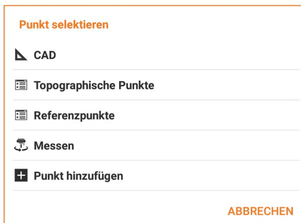
Der Punkt für die freie Station kann auf diese Weise mit dem GNSS-Empfänger gemessen werden. Der Punkt wird gemessen und zu der Punkteliste hinzugefügt und wird zum erforderlichen bekannten Punkt. Der Vorgang geht weiter mit der Messung des gleichen Punktes mit der Totalstation und damit wird der Messvorgang des bekannten Punktes für die Berechnung der freien Station abgeschlossen.
