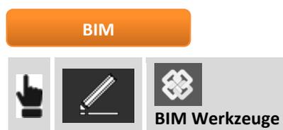
Mit diesem Befehl können Sie Punkte oder Polylinien aus IFC/BIM-Modellen extrahieren, die für nachfolgende Vorgänge verwendet werden können.
