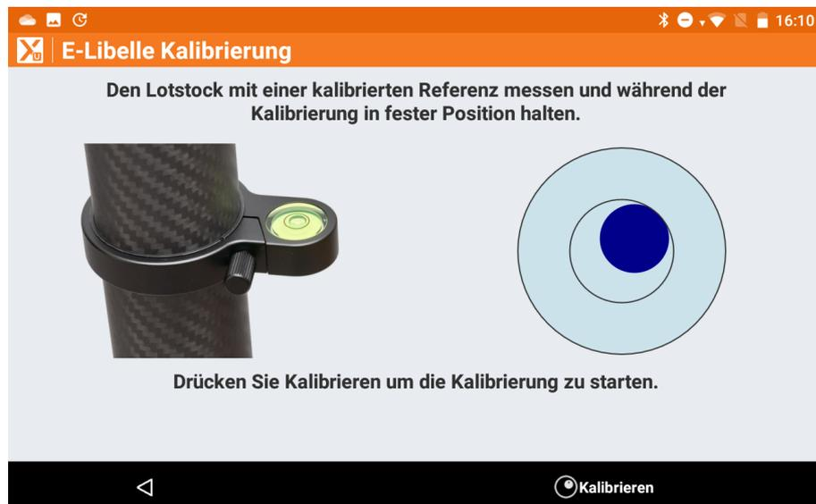
Zur Durchführung der Kalibrierung ist es notwendig, die physikalische Libelle zu verwenden, um den Lotstab für einige Sekunden perfekt im Lot zu halten. Am Ende des Kalibrierungsvorgangs entspricht die Position der elektronischen Libelle, die im Mess- und Absteckungsfenster angezeigt wird, der Position der physikalischen Libelle.
