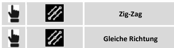
Nach der Aktivierung des automatischen Code-Modus wird der Code der ersten Linie in der Liste vorgeschlagen. Direkt nach der Messung des ersten Punktes wird der Code der zweiten Linie in der Liste vorgeschlagen, usw.
