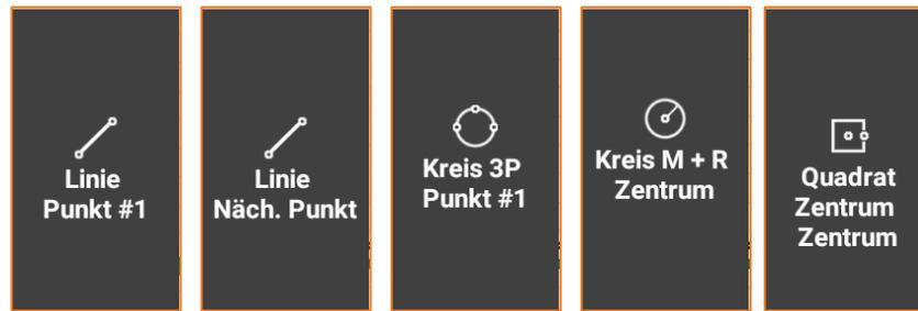
Wenn ein Messcode ausgewählt wird, wird automatisch das Werkzeug aktiviert, das dem Typ der Zeichnung entspricht, der im Code definiert ist.
