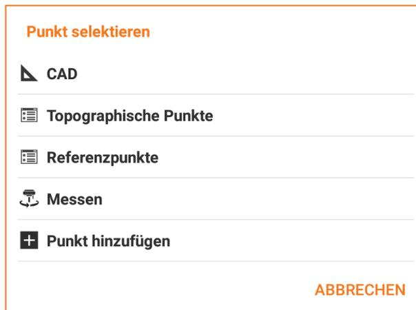
Der Rückvisurpunkt kann dann mit dem GNSS-Empfänger gemessen werden. Der Punkt wird gemessen und zu der Punkteliste hinzugefügt und wird zum erforderlichen bekannten Punkt. Der Vorgang geht weiter mit der Messung des gleichen Punktes mit der Totalstation und damit wird der Messvorgang des bekannten Punktes für die Berechnung der Orientierung der Station abgeschlossen.
