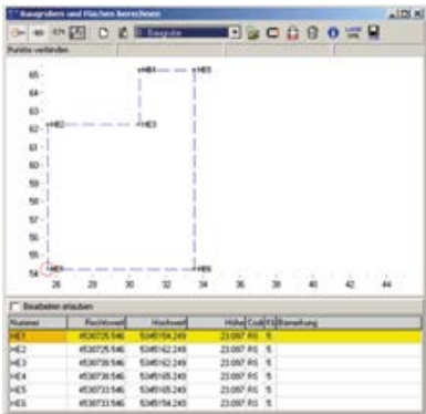
Grundriss der Baugrube mit Koordinaten, die z.B. mit einem GNSS-Empfänger aufgenommen wurden
