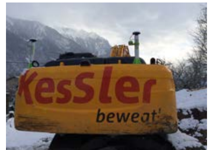
Einrichten eines Baggers mit GNSS-Empfängern
