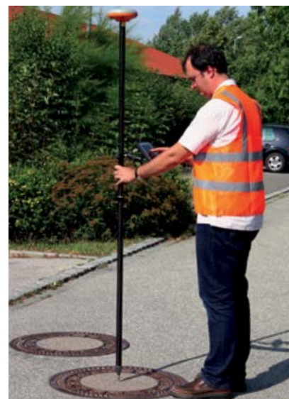
Verwendung des Tablets mit GNSS-Empfänger NR3 und Esri-Engine zur Aufnahme eines Kanaldeckels
