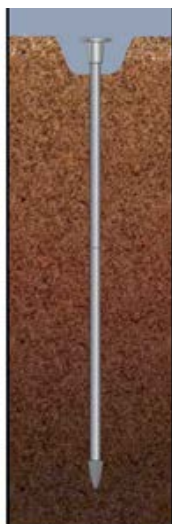
Stabvermarkung mit Profilabschluss
