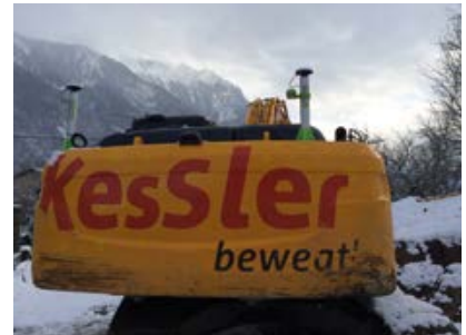
Einrichten eines Baggers mit GNSS-Empfängern
