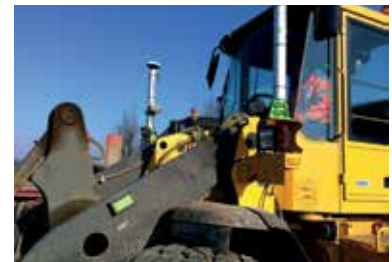
Zwei GNSS-Antennen auf dem Radlader
